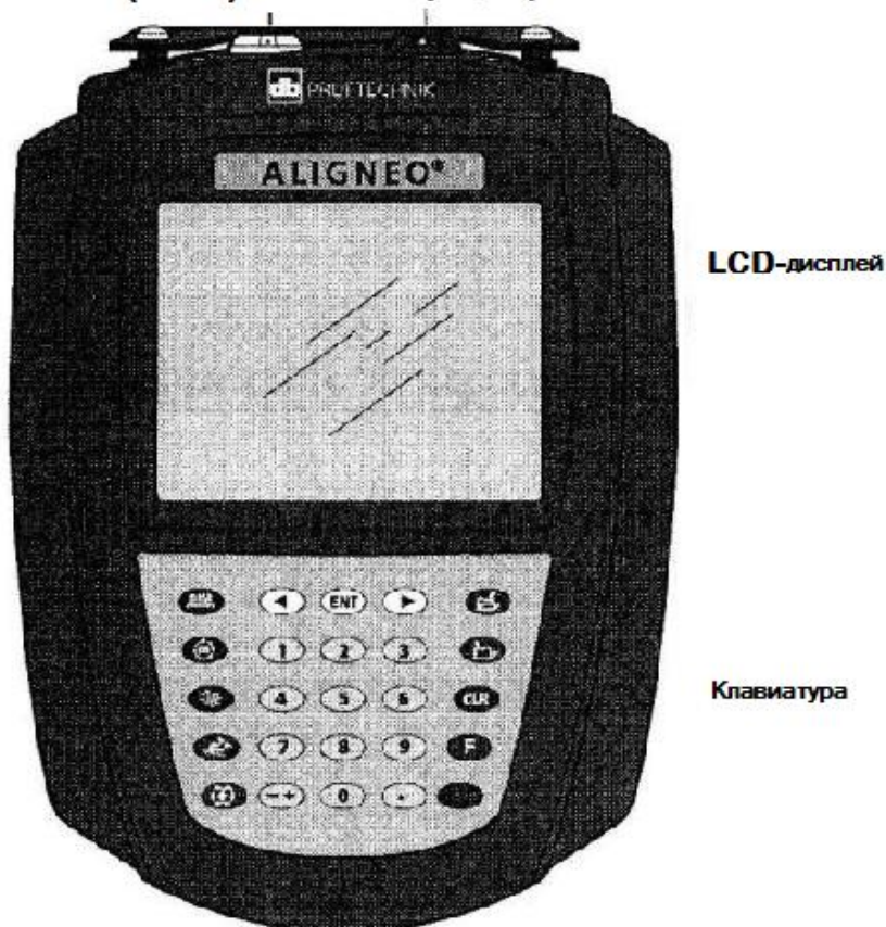
Устройство управления ALIGNEO - вид сверху
