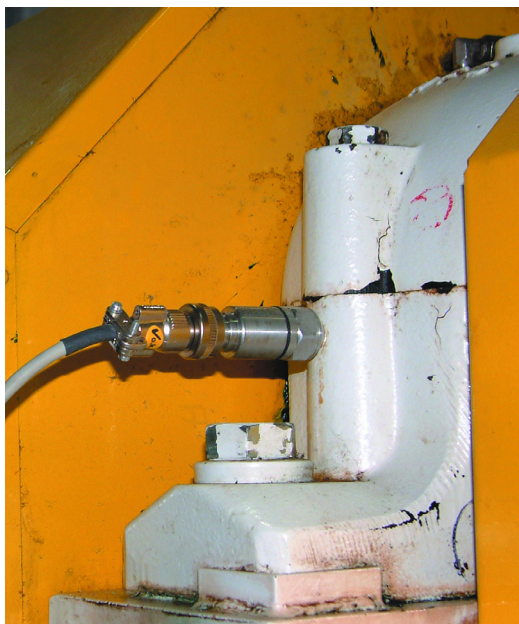
VIBROTECTOR устанавливается на корпусе подшипника
