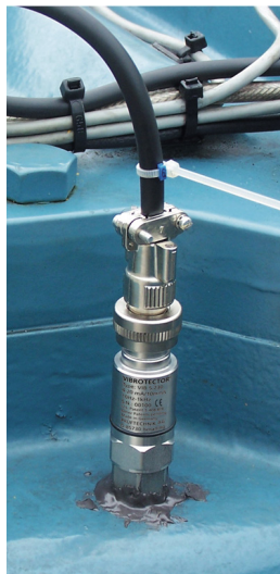
Установка VIBROTECTOR при помощи клеевого адаптера
