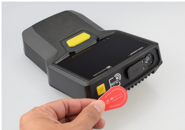
Идентификация точек измерений с помощью технологии RFID (ISO 14443a и ISO 15693)
