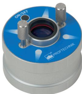
Датчик PENTALIGN прикреплен к основанию с помощью двух винтов в его верхней части. Черная кнопка выполняет функцию переключателя включения / выключения, который в то же время используется для настройки датчика. Четыре светодиода, расположенные на 90° друг от друга вокруг датчика, служат пользователю ориентиром во время точной регулировки основания. Датчик получает питание от одной батарейки AAA, которая размещается в нижней части датчика.
