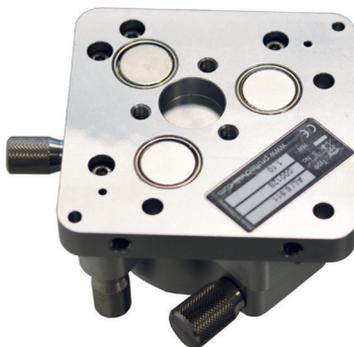
В нижней части основания расположены три мощных магнита, которые обеспечивают удобную и надежную фиксацию на металлических поверхностях. Кроме того, основание может быть прикреплено к переходной плите, которая устанавливается на монтажный треножный штатив (ALI 6.956). Основание PENTALIGN может быть установлено непосредственно на треножный штатив при помощи резьбового адаптера ALI 6.924.
