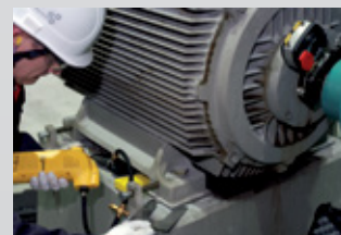
Дополнительно: Пластины (рис. слева) и подъемник для установки пластин.
