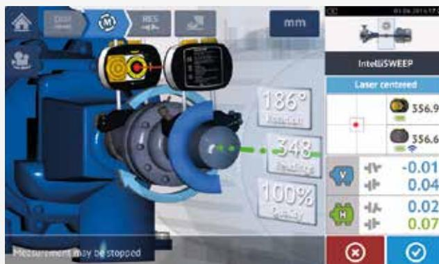
Во время вращения валов точность измерений отображается с помощью цвета параметров. Если значения отображаются зеленым или синим шрифтом — качество измерения хорошее.
