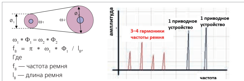
Изношенные, ослабленные или перекошенные ремни
