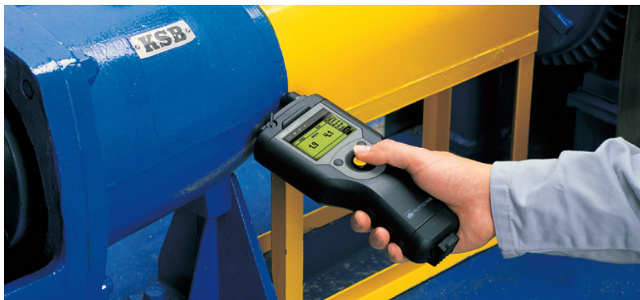
VIBSCANNER — популярная и недорогая портативная система СМ
