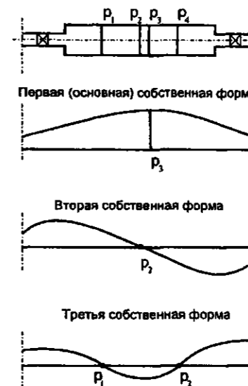
Рис. 1.20. Характерные собственные формы гибких роторов на податливых опорах
